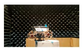
ローバーが月面を走行する際、方向や斜度に関わらず、 電波を最も確実に送受信できるアンテナの取り付け位置 や角度を推定するため、0.1 度単位で角度が変更可能な アンテナ回転台を用意し、水平方向:360 度/垂直方向: 30 度に対して測定を実施しました(パターンは 100 を超える)
