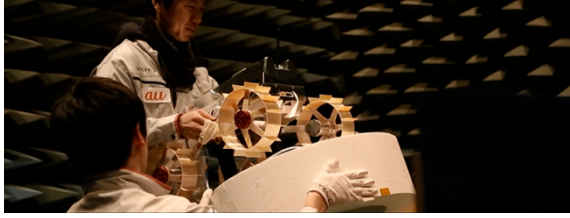
KDDI 研究所の電波無響室で試験を行うHAKUTO のローバー
