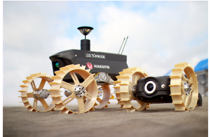
ホイールにウルテムを使用した HAKUTO の月面探査ローバー
