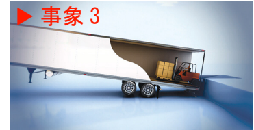
▶ 事象3 フォークリフトの重量による傾斜
