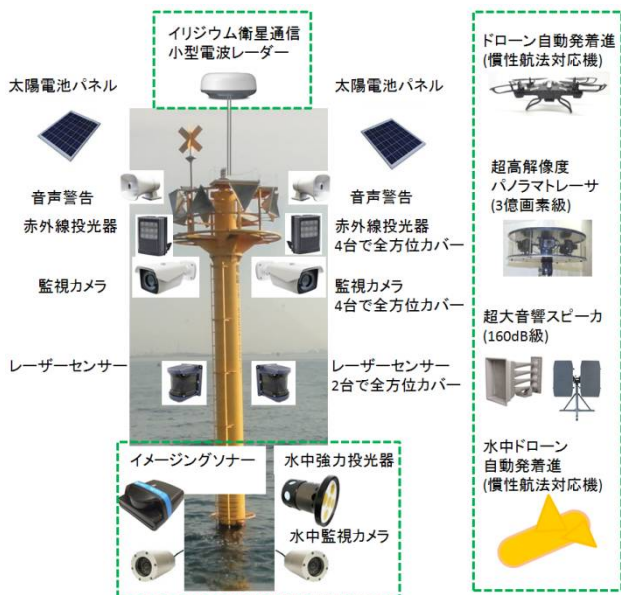
図-11 海上ブイ警備システム概念図
