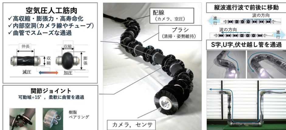
図1 受賞技術：蠕動運動型管内検査ロボット
