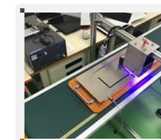
ベルトコンベヤー UV硬化
