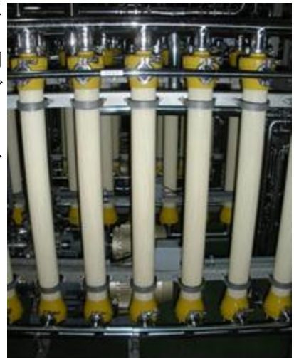
(右写真)生酒の超精密ろ過を行う限外ろ過機。縦のパイプの中に、何本も束になった細いチューブ状の膜があり、これで酒中の酵素を取り除きます。
