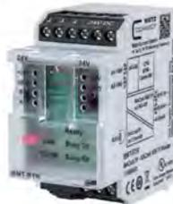
ゲートウェイ“WIO2-M-BM”は、ビル、機械、プラント、システムにおけるエネルギー消費量モニタリングやエネルギーモニタリングのための強力なデータロガーを搭載しています。デジチェーン機能を備えた2つのイーサネットポートは、より多くのデータロガーとLANネットワークが組めます。Modbus TCPまたはBACnet/IPネットワークに統合して制御タスクを実行できます。システムはプラットフォームに依存しないウェブブラウザでパラメータ設定、コンフィグレーション、コミッションングが可能です。M-BUSおよびModbus RTUインターフェースは、電気、水道、ガス、熱などの異なるメーターの読み取りが可能です。
