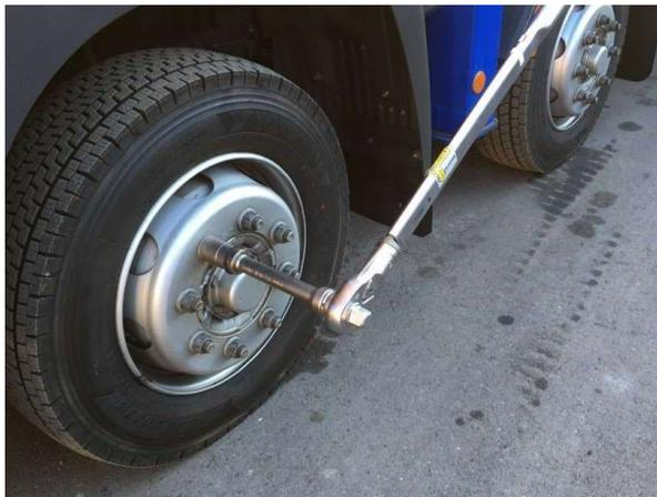
大型トラックのタイヤには、60～80個のナットが装着されています。そのため、毎日の運行前点検作業には30分程度が必要です。当社のゆるみにくい『脱落防止ナット』を使用することで、点検、増し締めの回数を削減することができ、メンテナンスは月に1回程度でよくなります。すると、毎日30分×就業20日間＝600分(10時間)の労働時間削減につながります。これは、ドライバーの就業時間規制が厳しくなる2024年問題の解決にも寄与します。
