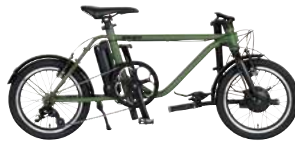
ハンドルステム折り畳み機構付き セミフォールディングタイプで収納・持ち運びに便利
