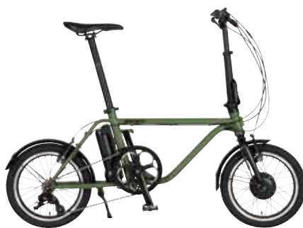
総重量約15.1kgのクロモリフレーム採用のE-BIKE
