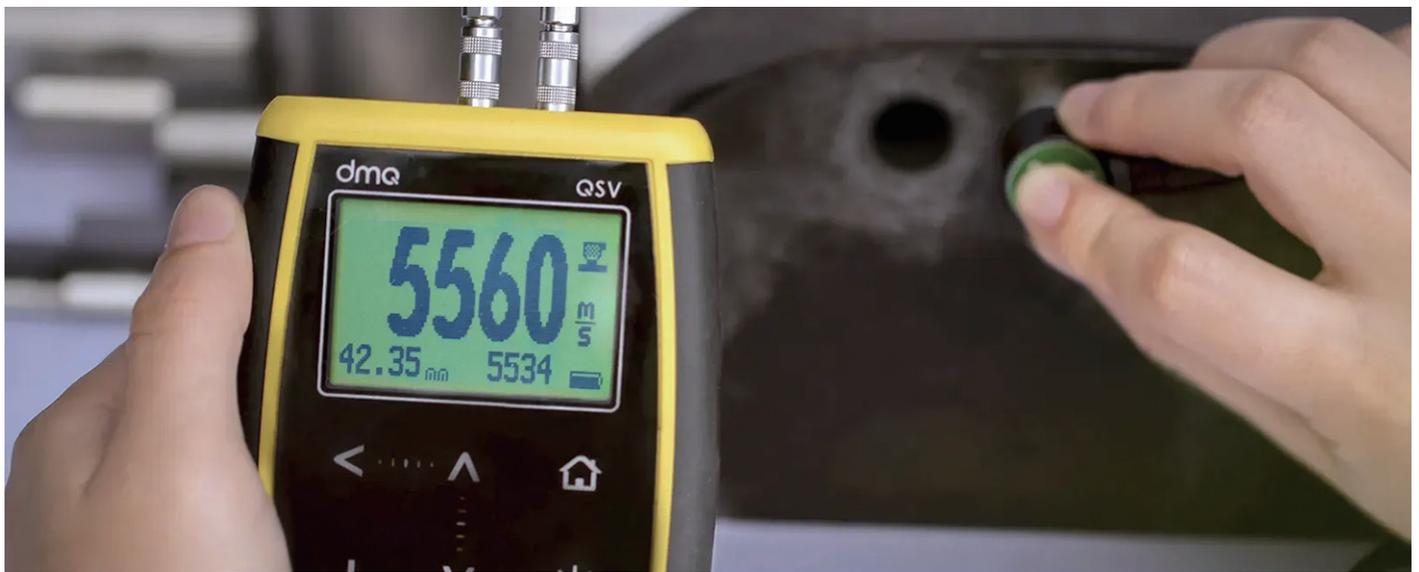
100~19,999m/秒の音速測定範囲と、感度およびパルス電圧の調整機能により、音速が遅いシリコンゴムから速いセラミックスまで、さらに薄物から厚物、高減衰材まであらゆる材料に対応
