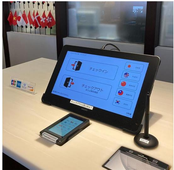
スニットコンピュータのセルフチェックイン精算機「Finexit(ファインジット)」は、ロビーなど設置場所のインテリアに合わせたオリジナルの筐体をカスタマイズでき、セルフチェックイン機までの動線、お客様の操作性など、すべて考慮した上で設置ができるオンリーワンのセルフチェックイン精算機です。
