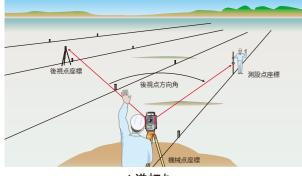
既知の「機械点座標」と「後視点座標」(または「方向角)」お よび、「測設点座標」に基づいて、三次元で逆打ちを行いま
