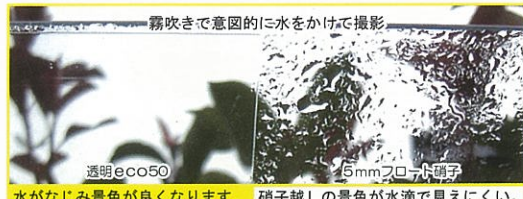
霧吹きで意図的に水をかけて撮影 透明eco50 5mmフロート噴子 水がなじみ景色が良くなります。硝子越しの景色が水滴で見えにくい。
