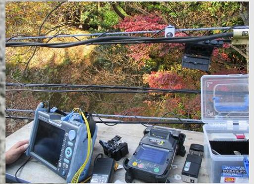
FTでの架線から1ヵ月後の検査でコウモリガによると思われる穴をケーブル側面に発見。しかしOTDRによる検査では、ファイバは断線していないことが確認された。その後、そのまま経過観察を続行し、導通が確認できています。
