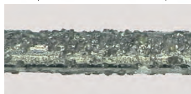
φ170μm径、ダイヤモンド径30μm
