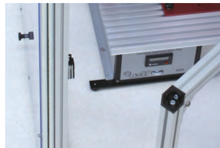
安全SW 扉解放時にマグネットキャッチSWが動作し機器停止
