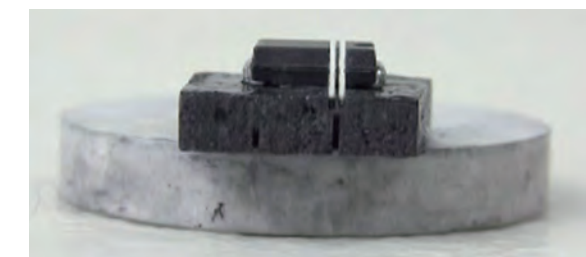
φ300μm径ワイヤー使用 切断時間5分
