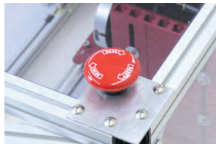
緊急停止SW 緊急時に押すと機器停止
