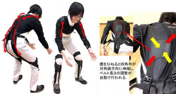
図3 膝を曲げると腕が上がる構造と腰をひねったときの調整
