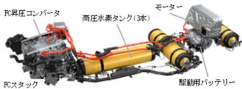
図1 システム図およびシステム搭載図
