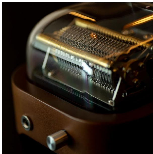
左) 特殊なシリンダーを開発、右) 振動する櫛歯（くしば）を保護する仕組みが特許を取得
