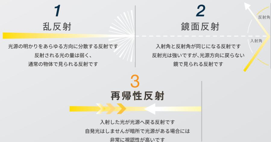
反射テープは再帰性反射の原理を用いて製造されています。
