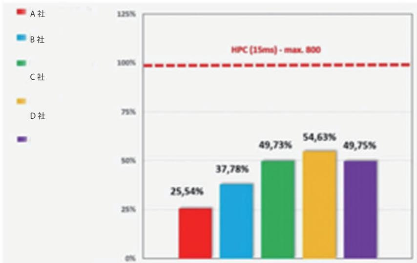
頭部損傷基準をテスト結果より計算し、頭部損傷数値を比較するとスマートキッズベルトは損傷基準を大きく下回る数値結果になる。
