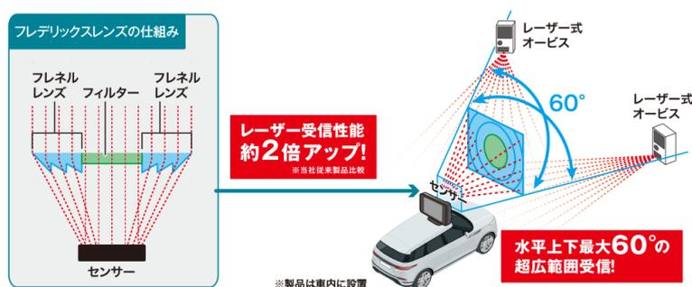
※フレネルレンズ構造とは従来の光学レンズが持つ曲面を一連の同心円状の溝に置き換えたもの。
