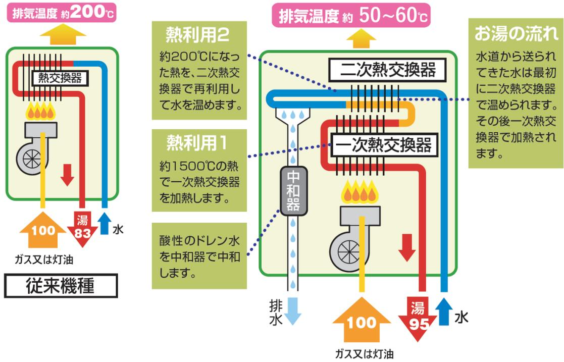
(図：高効率給湯機の構造)
