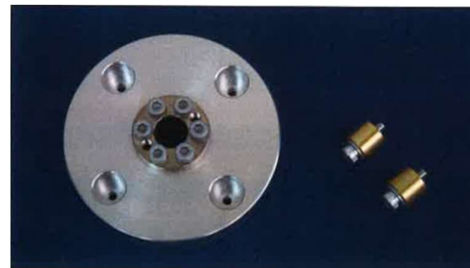
偏荷重 ：回転体と偏荷重用の重り
