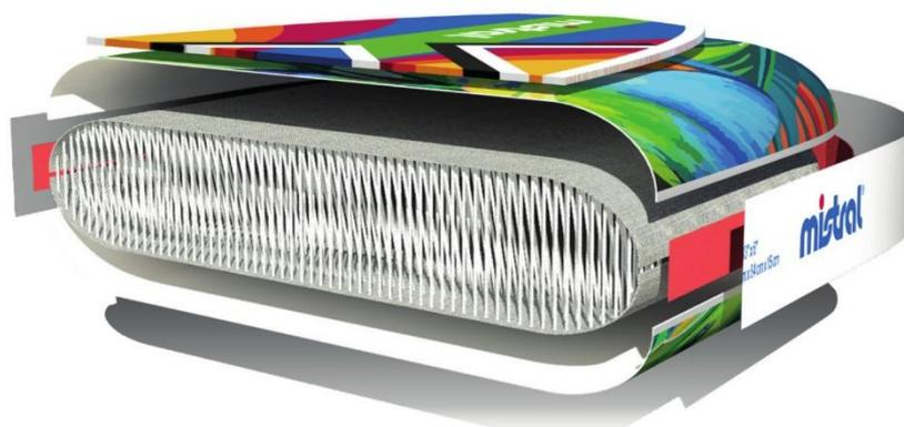
DSFLとは、デッキとボトムのPVCシートをクロス織にした極細のポリエステルドロップステッチ糸を溶解技術により一体成型したものです。既存の技術に比較し、大幅な重量の削減ができ、且つ、強度及び剛性が大幅に上昇しました。数年前までは、5,000本/インチ四方が標準（当社比）であった、ドロップステッチ糸は、DSFLでは、13,600本/インチ四方まで増加しています。結果的に、軽量で剛性が高く走行性能が高い丈夫で長持ちのインフレーターボードが完成しました。
