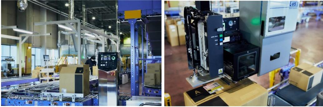
最新鋭の設備への転換により、正確性も向上。コンベアを通った瞬間に箱の重さを測るウェイトチェッカーもその1つ。空箱の重量と製品ピックアップ後の重量をオーダー情報から計算。2gでも計算値と差がある場合は、さらに人の目で検品を行っています。高性能なカメラシステムによる映像での品質管理や、箱へのダメージを軽減するコンベアへの総入れ替え、出荷ラベルの自動貼り付けマシンなど、配送トラブルを減らすための各種改善から、日本全国の皆さんへ高品質で安定した配送サービスの提供を実現していきます。
