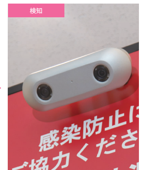
すり抜けや共連れによる入館を3Dセンサーが検知し、警告・録画・通知等を行います。
