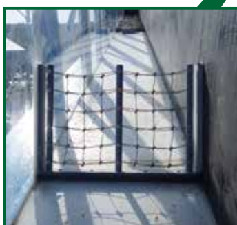
土石流捕捉前(正面)
