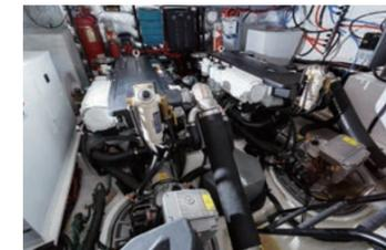
パワートレインはVOLVO PENTA D6 IPS 600、435馬力を2基掛け。オプションでIPS 500仕様もある。11kWのKOHLER製ジェネレーター、SEAKEEPERなども搭載。
