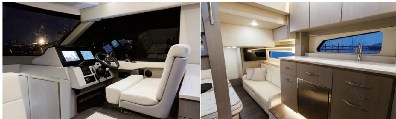
42フィート艇とは思えないほどのボリューム感あるメインサロン。左舷に大型ソファとラウンジテーブルを配し、右舷にはL字型にレイアウトされたアッパーギャレー。右舷前部のロアステーションからは全周方向の視界が確保されている。ロアデッキのオープンエアアトリウムにもダウンギャレーが備わる。
