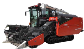
図 1. 自動運転アシスト機能付きコンバイン WRH1200A
