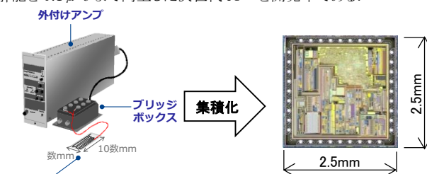
図 1 ひずみ計測システムの IC 集積化イメージと IC チップ外観
