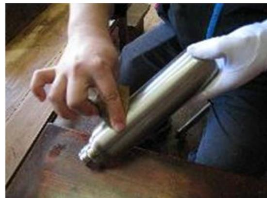
下地塗後、サンドペーパーで1つずつ手作業で研磨します。
