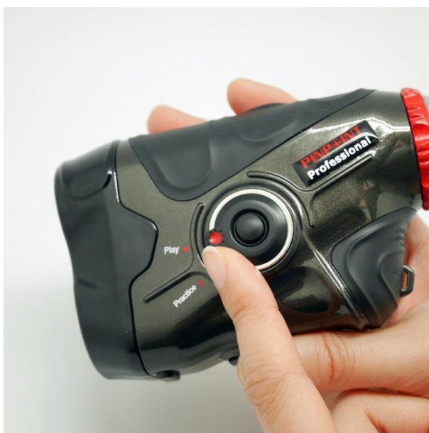
モード切替スイッチでプレーモードとプラクティスモードを切り替え
