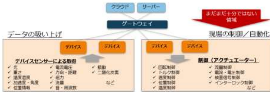
図 1.製造現場を IoT で可視化する際のデータの流れ
