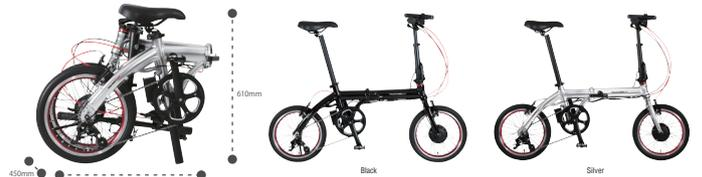
最大の特徴であるハンドル中央部に配置されたマグネット脱着式のモバイルバッテリーシステムをそのまま継承し、更なる軽量化と走行安定性を実現する前輪モーター方式を採用。前輪に収まる小型モーターユニットは上り坂でもパワフルな走行を実現します。
