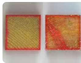
呈色反応試験で浸透を確認 (ホウ素 2500ppm で発色)
