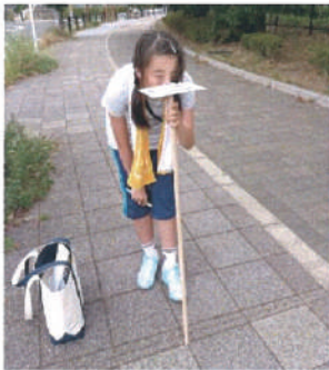
↑計測点に狙いを定め、方位盤で方位を測っている
