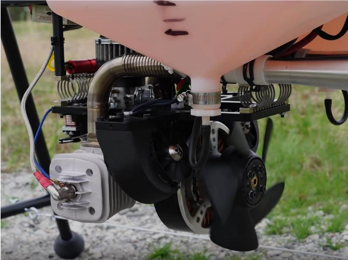
(画像7：当社導入機体ハイブリッド電力システム)
