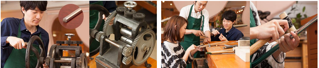
圧延ローラーで金属を伸ばし平らにする工程
