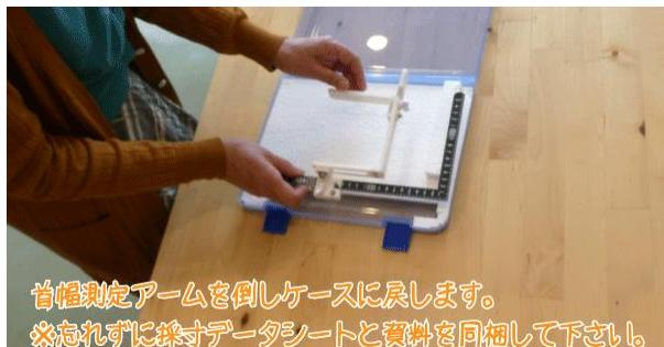
首幅測定アームを倒しケースに戻します。
