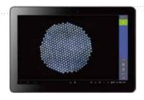
▶ タブレット端末を鋼材断面に かざして写真を撮影
