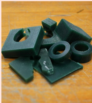
ジュエリー製作で発生する端材(左)を、練習用のワックス(右)に再生
