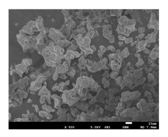
LLZOの電子顕微鏡写真 (SEM)
