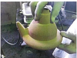
ザク鉄瓶の為に制作された専用の中子(なかご) 中子を鑄型に設置
