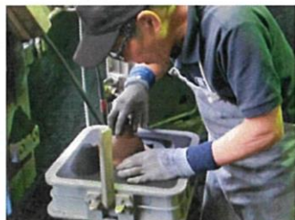
ザク鉄瓶の為に制作された専用の中子(なかご) 中子を鑄型に設置
