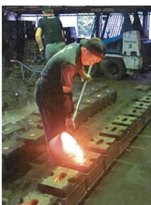
注湯(砂型に職人が一つ一つ溶解した鉄を流し込む)
