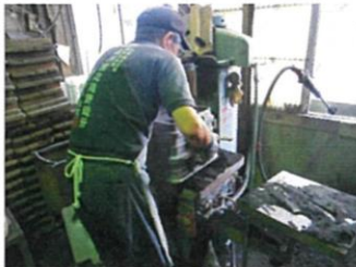
上型と下型を合わせ、砂枠外して砂型完了
