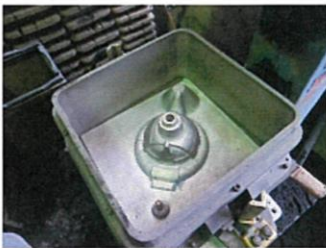
砂型金型を型作りの枠にセット
