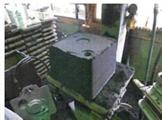
上型と下型を合わせ、砂枠外して砂型完了
