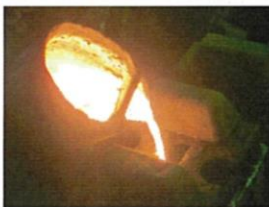
注湯(砂型に職人が一つ一つ溶解した鉄を流し込む)
