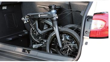
メインチューブには炭素繊維、TORAY T700 カーボンファイバーを採用し フレーム強度の要となるジョイント部分には一体式アルミ鍛造ジョイントを内蔵。 スマートで美しいフレームラインと、しっかりとしたフレーム剛性を兼ね備えています。
