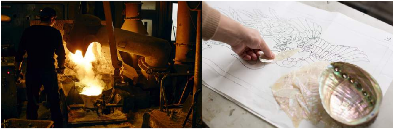
高岡銅器：千数百度の高温で溶かした金属を型に流し込む鋳造法
