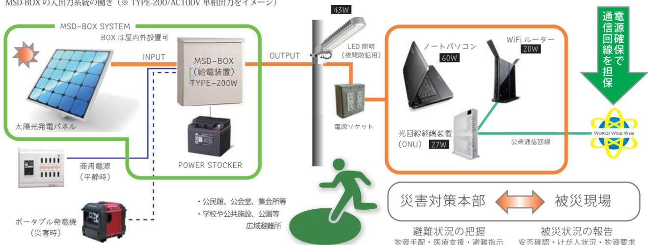
日中は太陽光発電エネルギーをそのまま商用電力として利用します。曇天時または夜間は蓄電した電力を利用するか、夜間電力が利用できます。夜間停電の場合は蓄電電力に加え、外部発電機から電力を入力できるので、高確率で二次側に電源を供給します。
