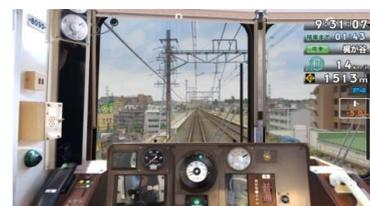
東急線8090系実写版運転シミュレータ
