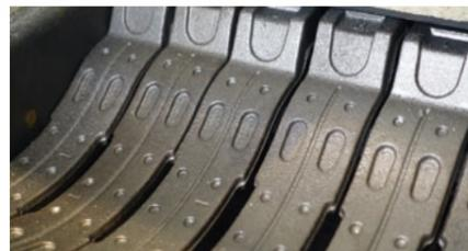
特殊構造のグレートはグレート同士の隙間を少なくすることで熱損失を軽減させます。また中央にくぼんだ形状が自然な灰の堆積を促し、燃焼効率を向上させ、グレートの長寿命化を実現しました。
