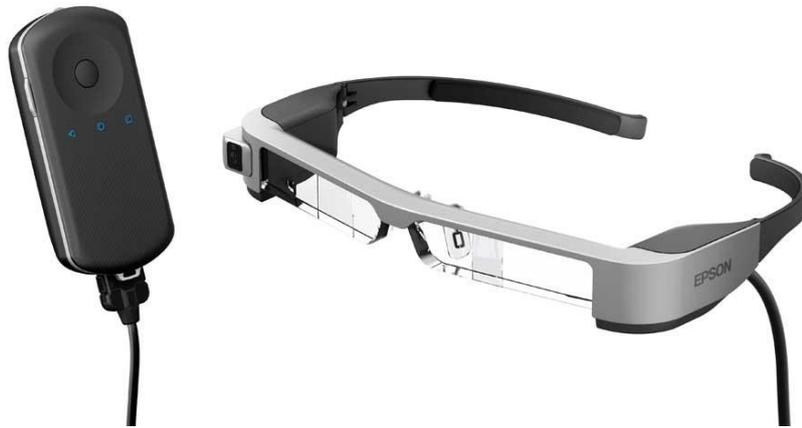
“MOVERIO『BT-300』”は、メガネのようにかけるだけで、目の前に大画面が現われる、両眼シースルータイプのスマートグラスです。『BT-300』は MOVERIO シリーズとして初めて光学エンジンにエプソン独自の超小型高精細カラーのシリコンOLEDディスプレイを新たに採用しています。
