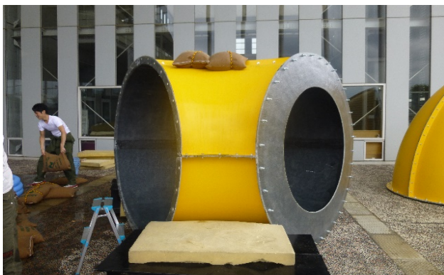
静的負荷試験：10kg の土嚢をシェルター頂部に積み上げ、合計 800kg の載荷を実施
