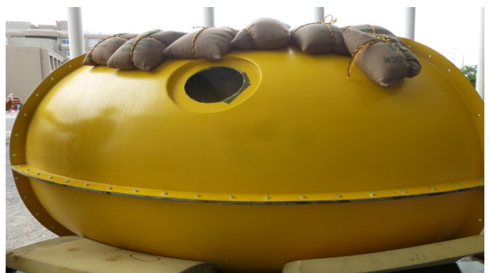
静的負荷試験：10kg の土嚢をシェルター頂部に積み上げ、合計 800kg の載荷を実施
